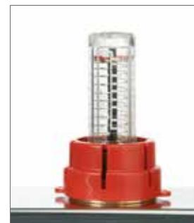
Im Vorlaufbalken ist für jede Heizgruppe ein Durchflussmengenmesser integriert. Die Durchflussmengenmesser lassen sich von 0-5 l/min einstellen und ermöglichen den idealen hydraulischen Abgleich der Heizkreise untereinander.
